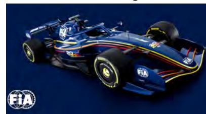
Die 2026-er-Autos werden mindestens 768 kg wiegen, der Abtrieb wird um 30 Prozent und der Luftwiderstand wird um 55 Prozent reduziert.
