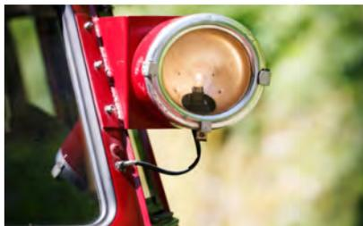
Damit der „Schienen-Bulli“ den Vorschriften für Nebenfahrzeuge der Bahn entspricht, wurden die Leuchten an der Front und im Heck ausgebaut, verblecht und stattdessen die im Bahnverkehr vorgeschriebenen Standardlampen vorne (2 x weiß) und hinten (1 x rot) an neuen Positionen an bzw. eingebaut.
