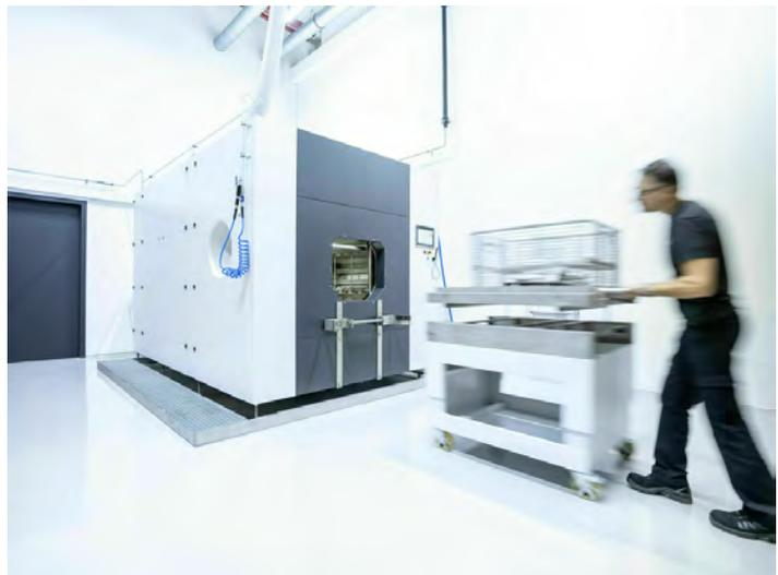
Hochdruck-Waschmaschinen zur Reinigung von Motor-Bauteilen
