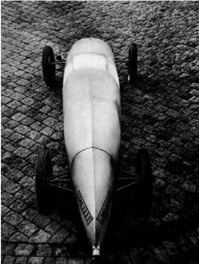
Das Gewicht des Gefährts betrug rund 380 kg, auch dank der leichtgewichtigen Aluminium-Karosserie, die auf einem filigranen Rohrrahmen saß. Motor und Getriebe saßen bei der Imperia-Konstruktion vor der Hinterachse.
