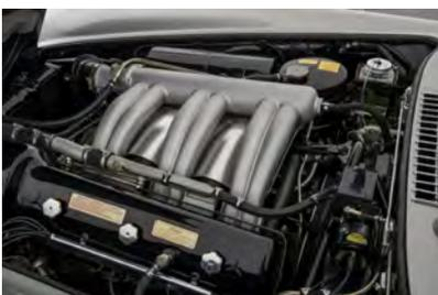
Startet der Motor im kalten Zustand mit der Zusatzpumpe und dem Choke gut und läuft nach kurzem Warmfahren geschmeidig und geräuschfrei rund, dann hat man ein Indiz für einen ordentlichen Motor.
