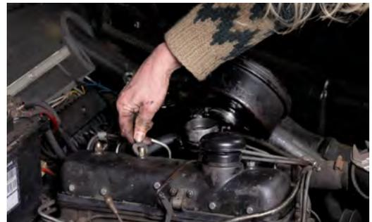
Den Ventildeckel wird einem Maulschlüssel demontiert
