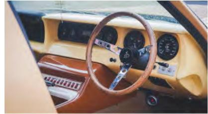
Gestartet wurde der Wagen mit einer ungewöhnlichen Prozedur. - Auf dem Pult links in der Mittelkonsole mussten mehrere Schalter (u.a. für die Benzinpumpen) in bestimmter Reihenfolge gedrückt werden.
