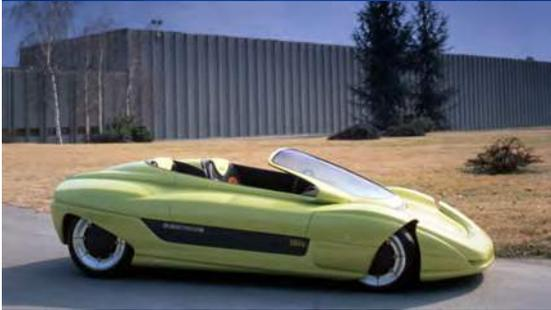
Gemäß damaligen Angaben beschleunigte der nur 650 kg schwere Sportwagen in sechs Sekunden von 0 auf 100 km/h. Dafür reichten im zwei Motoren mit je 28 kW oder 37 PS, Gesamtleistung also 56 kW oder 75 PS, umgerechnet weniger als neun Kilogramm pro PS.
